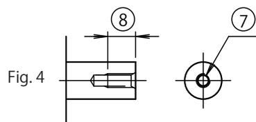
注) ねじはメートル並目ねじです。 Note: A thread is a metric coarse thread.
