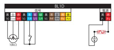
上位側のコントローラからの信号で動作させる接続例
